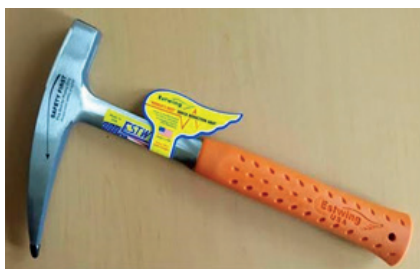
FIGURA 4. Martillo de geólogo o Picca, con el cual se extrae muestras de rocas o minerales.
