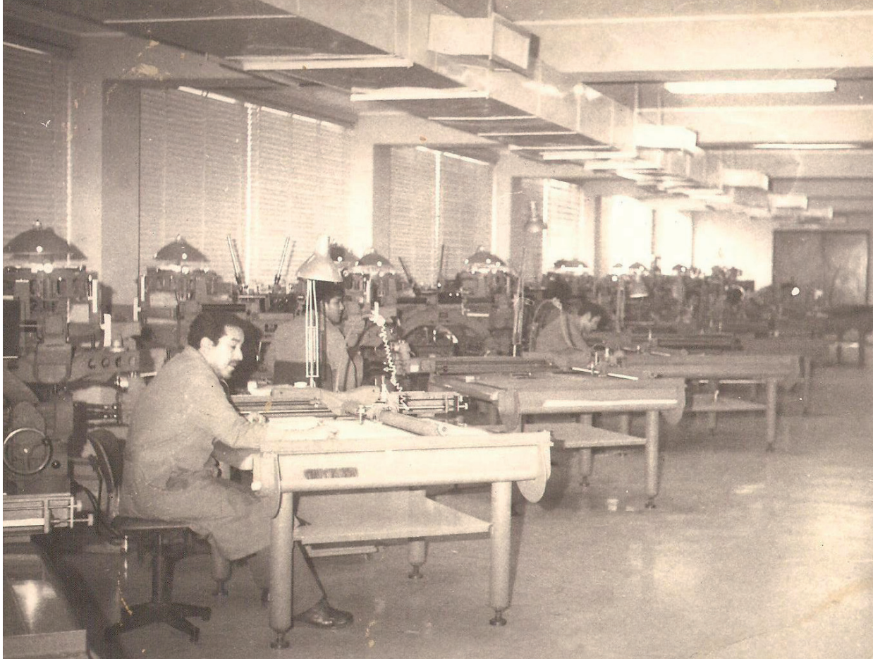
Personal del Instituto Geográfico Militar realizando trabajos de restitución aerofotogramétrica operando los aviógrafos Wild A 10.
